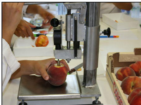
Figura 1.12. Penetrómetro (método destructivo) utilizado para la medida de la firmeza del melocotón.
