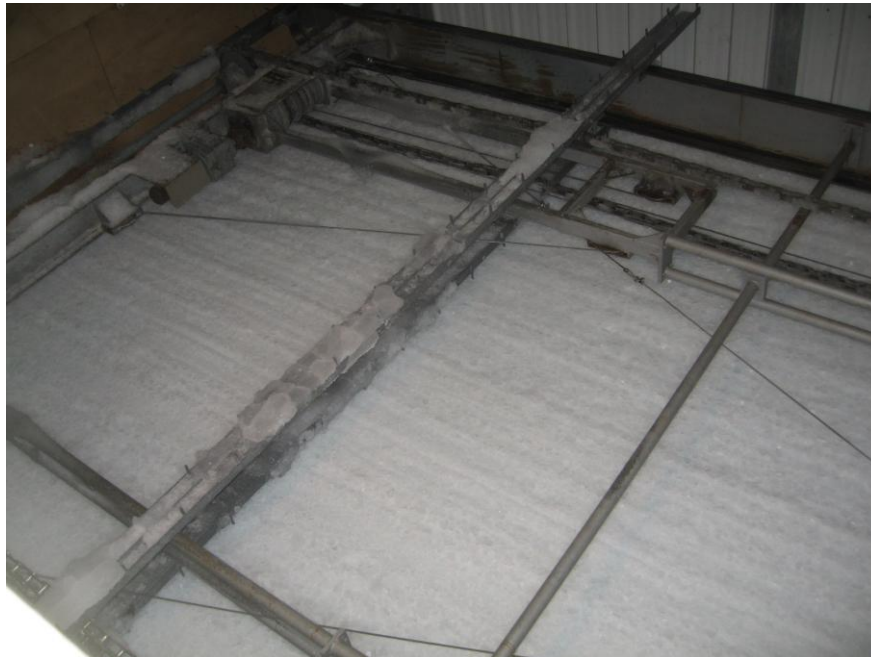
Figura 6. Silo de hielo en escamas, en España suelen ser de capacidad de 150 a 500 ton.
