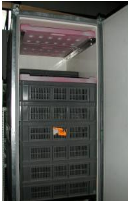
Figura 11. Armario aislado con placas de PCM, para conservar y enfriar el pescado
