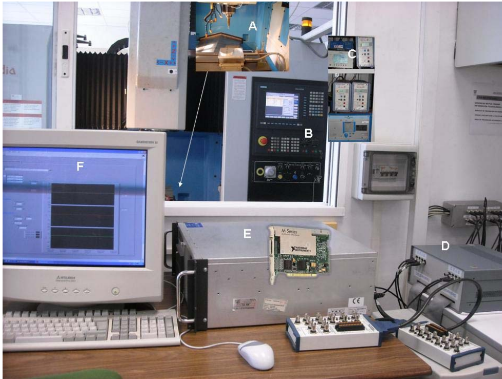
Figura 3.1: Plataforma experimental: A) Sensores en la mesa de trabajo. B) CNC. C) Amplificadores. D) Sistema de adquisición de señales. E) Ordenador industrial para manipulación de las señales adquiridas. F) Programa Labview.
