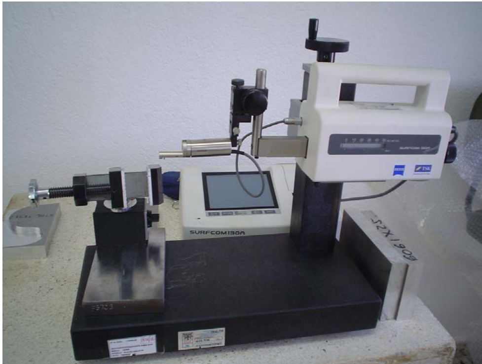
Figura 2.13: Rugosímetro Surfcom 130, usado en este trabajo para medir el acabado superficial
