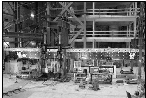
Figura 8. Ensayo y monitorización de las vigas a escala 1:1.
