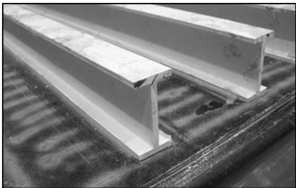
Figura 9. Conectores de fibra de vidrio AR/políéster adheridos a la viga de carbono/epoxi.
