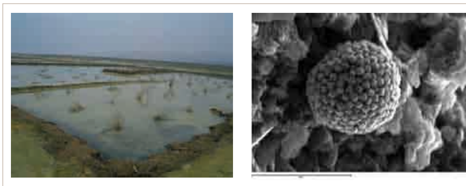
Figura 6.4.2. Humedal reductor construido sobre residuos mineros en la bahía de Ite (Perú). La zona gris oscuro del fondo muestra la precipitación de sulfuros de metales por la reducción del sulfato disuelto (proceso R2 de la Figura 6.3.2). Imagen de Microscopía Electrónica de Barrido de un agregado de cristales de pirita del sedimento anterior
