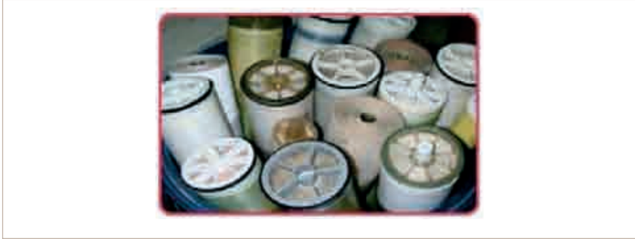
Figura 12.3.3. Módulos de membranas bajo la configuración de enrollamiento en espiral
