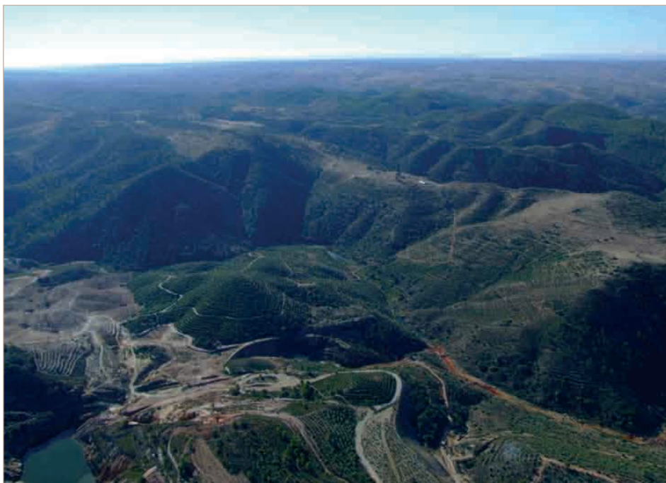
Figura 6.3.1. La minería contribuye drásticamente a la movilización de los metales. Vista aérea de la mina Tinto-Santa Rosa (Huelva). En la parte derecha de la fotografía se puede observar el cambio de color a rojo de un arroyo a causa de un drenaje ácido de la mina
