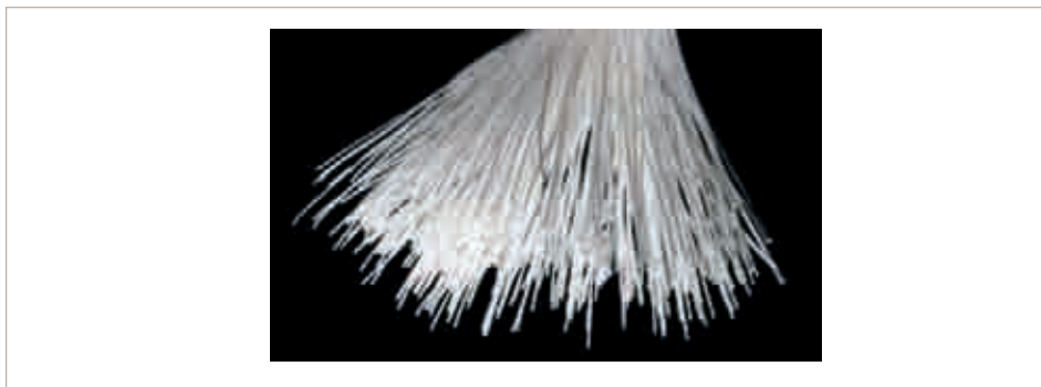
Figura 12.3.2. Membranas bajo la configuración de fibra hueca
