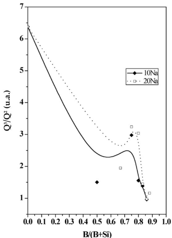
Figura 6. Relación  $Q^3/Q^2$  en función del contenido en B.
