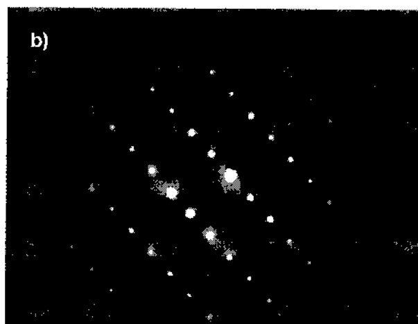
Figura 7. Microestructura de la muestra tras un tratamiento isoterma a 623 K durante 1 h. a) Imagen de campo claro donde se observan precipitados en forma de placas. b) Diagrama de difracción de electrones. Eje de zona [11\bar{2}0] .
