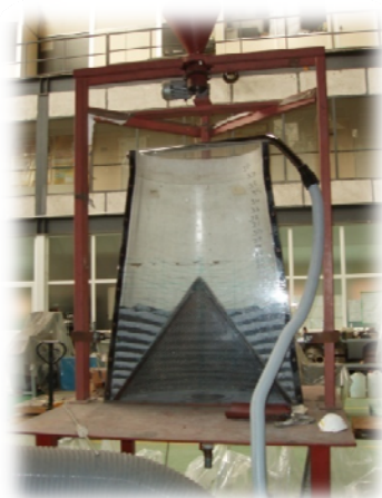
Figura 11.- Instalación piloto para el estudio y modelización de la circulación de gases en el horno alto (Zona Cohesiva)(2003)
