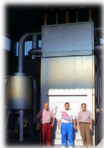
Figura 12.- Cámara de combustión instalada en Avilés para el estudio del "raceway" (2002).
