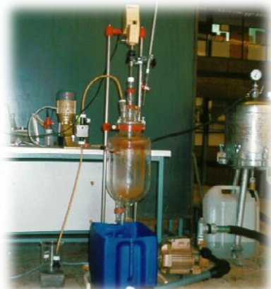
Figura 15.- Planta piloto de obtención de ferritas a partir de aguas de decapado tratadas con bacterias (1999)
