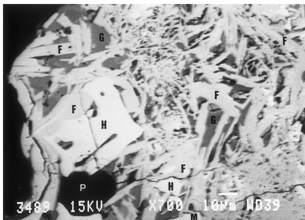
Figura 7. Detalle del borde izquierdo de la partícula mostrada en la figura 6 (x700). H=hematita; F=ferrito; F=red de ferritos aciculares y columnares; G=ganga; P=poro.
