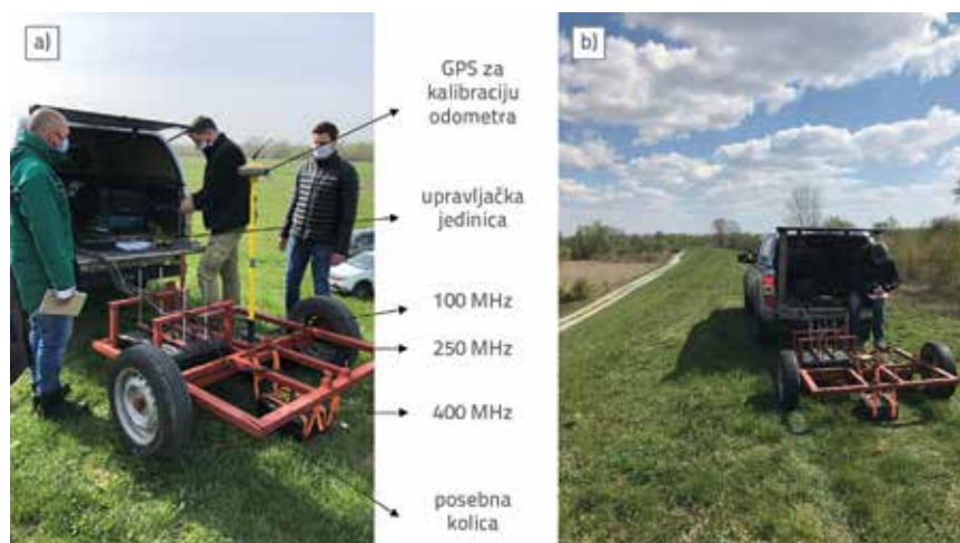
Slika 14. Ispitivanje oštećenja savskih i uspornih nasipa u gradu Zagrebu i okolici nakon potresa u ožujku 2020.: a) prikaz opreme za prikupljanje podataka, b) provedba prikupljanja podataka
