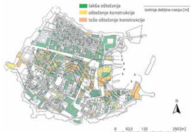
Slika 9. Izolinije debljine nasipa (od 1 m do 7 m debljine) u Starom gradu u Dubrovniku, preklapljene s prikazom oštećenja građevina za potres iz 1979. godine, modificirano iz [35]
