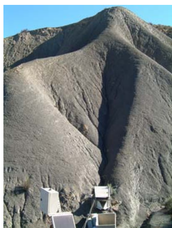
Fig 17.- Microcuenca elemental (cárcava) instrumentada con aforador H, junto a sistema de telecontrol (foto Solé Benet).
