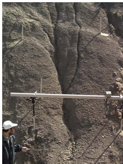
Fig 16.- Microperfilómetro láser para medir la pérdida de suelo (foto Solé Benet).
