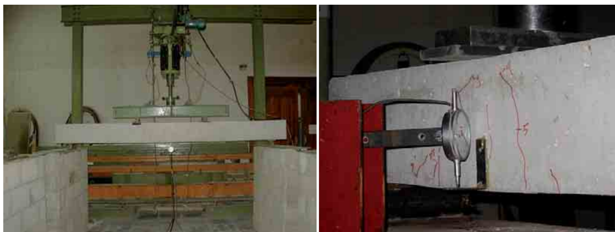
Figura 5. Dispositivo de ensayos a flexión en vigas.
