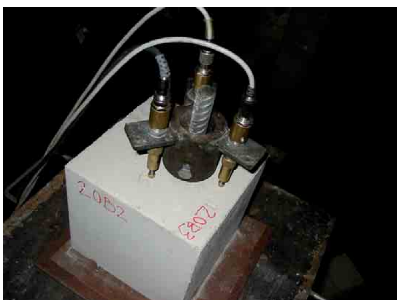
Figura 3. Probetas y dispositivo del ensayo pull - out.
