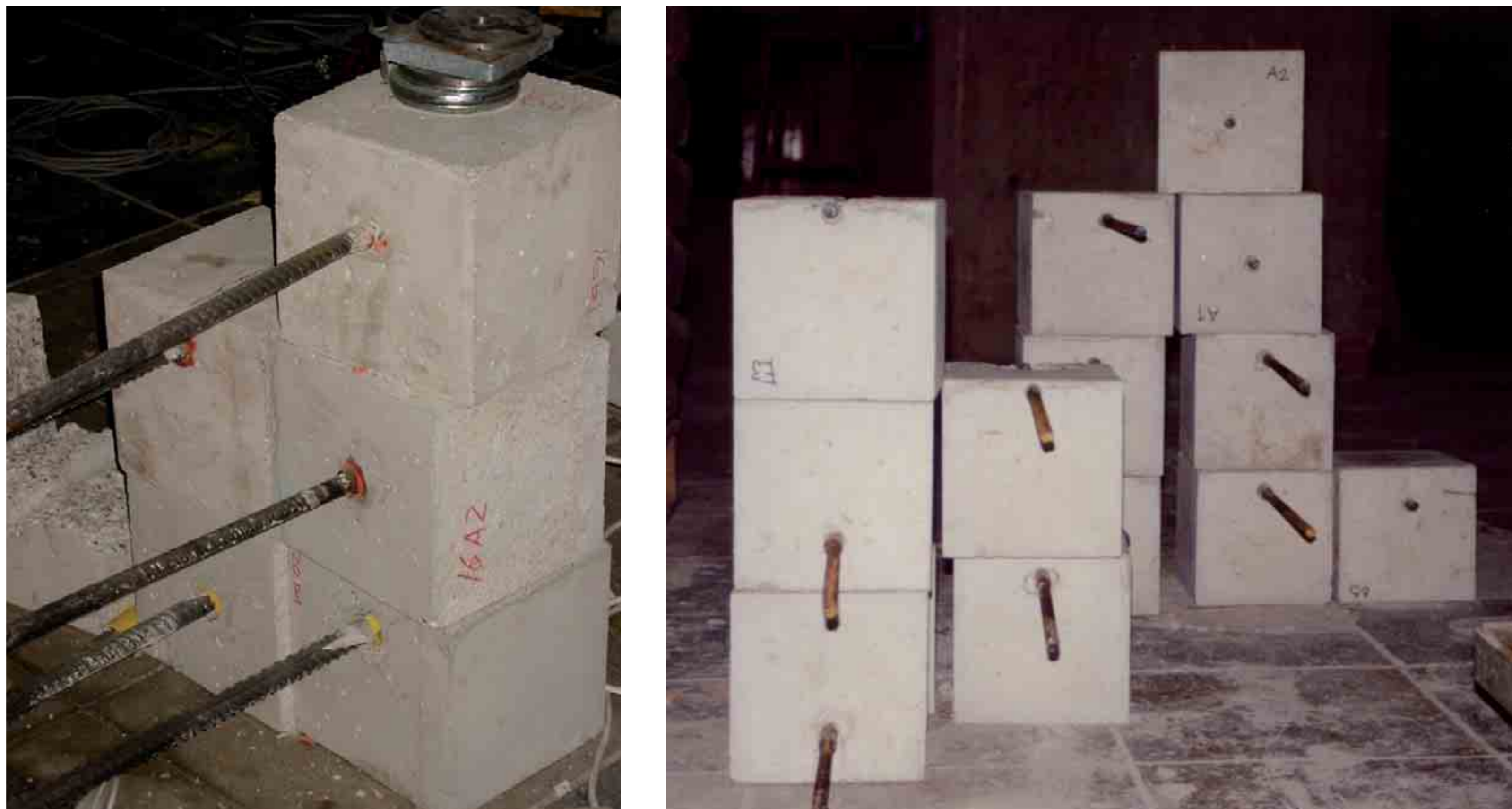
Figura 2. Probetas del ensayos pull - out.
