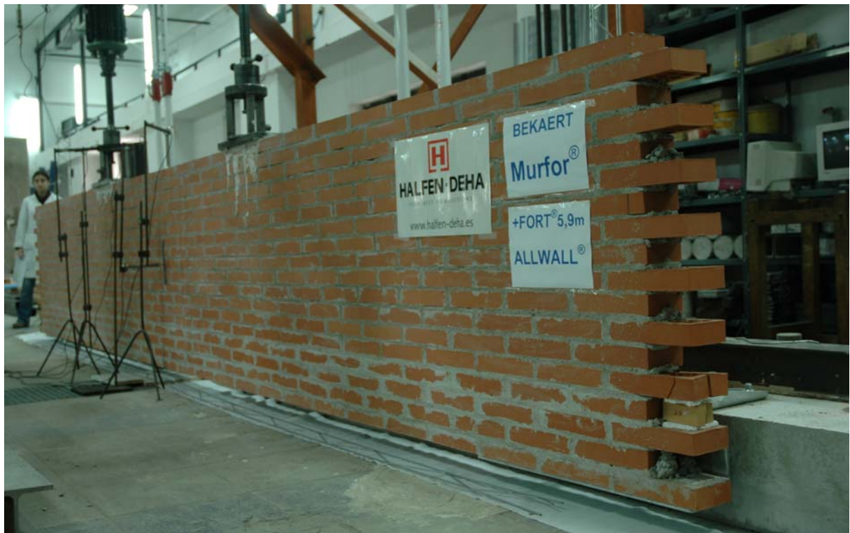
Fig.10. Dintel sobre los apoyos Pi a 6m de distancia, antes de su ensayo.
