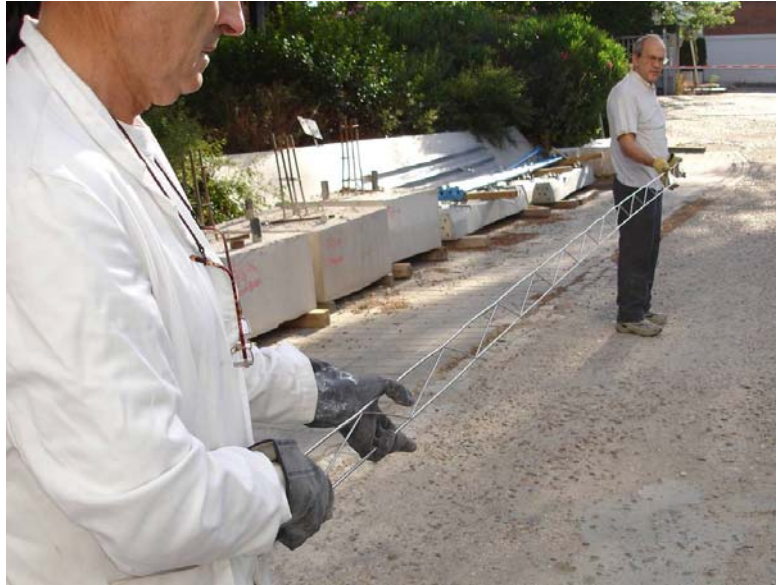
Fig.5. Armadura de tendel Murfor RND.5/S-80mm, fabricada de 1 pieza con la longitud de 5,85m. Se evitan así errores de falta de solape en el tirante de los dinteles de 6m de luz.
