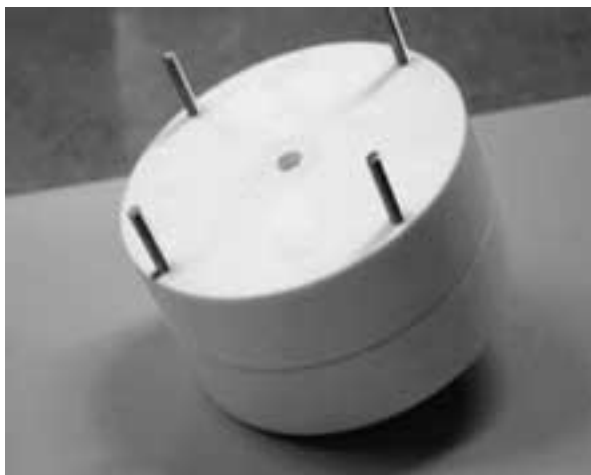
Figura 2. Array en cruz para exploración de fondos mostrando la disposición de los emisores elementales y una vez encapsulado.
