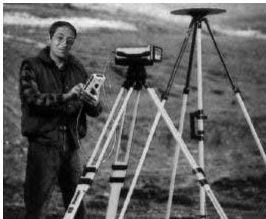
Figura 1. Por medio de un GPS con corrección diferencial puede situarse un punto cualquiera con precisión centimétrica.
