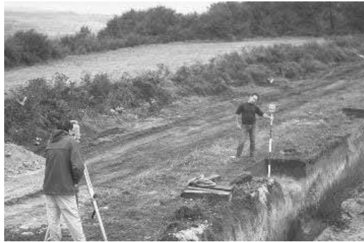
Figura 17. Registro de piezas con estación total en un pequeño sondeo de evaluación abierto en un yacimiento descubierto durante el seguimiento arqueológico de un gasoducto en Galicia.
