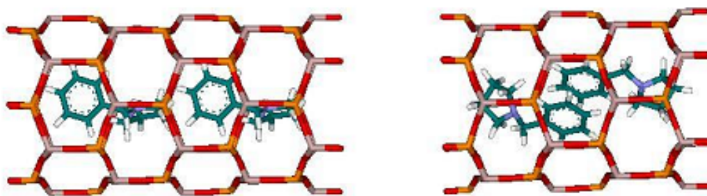
Figura 5.24. Dos posibles aproximaciones de los ADEs: en lados opuestos (izquierda: modelo 2ADE-op) o enfrentados entre sí (derecha: modelo 2ADE-enf).
