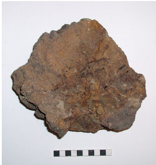
Figura 84. Detalle de la escoria analizada.
