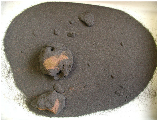
Figura 2.28. Lecho de Cu 21 Al-WI-950 sacado del reactor después de aglomerarse.
