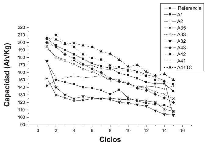
Figura 5.- Representación gráfica de la Capacidad específica, a un régimen de descarga de C/6, vs. ciclos de descarga para diversas muestras del híbrido PANi/ $V_2O_5$  obtenidos con diferentes tipos de agitación.
