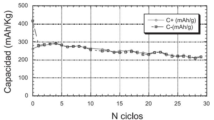
Figura 9b.- Evolución de la carga específica de la celda  $60V_2O_5:15NiO:25TeO_2$  frente a litio en función del número de ciclos.
