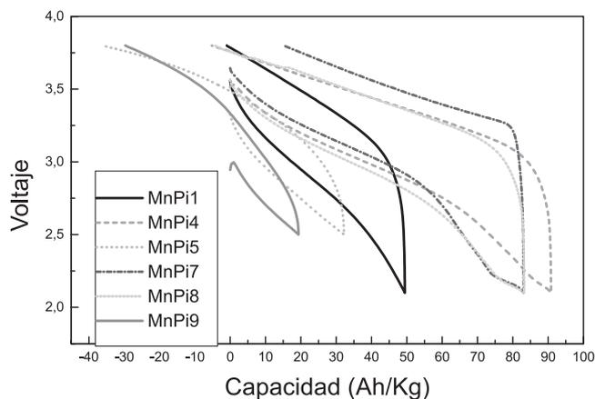
Figura 3.- Gráfico de la primera descarga de los híbridos PPI/MnO<sub>2</sub>, a velocidades de carga-descarga lenta (C/35).
