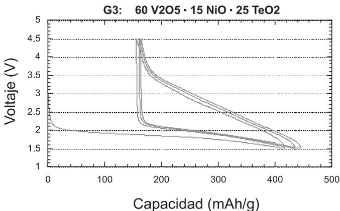
Figura 9a.- Curvas de carga y descarga de electrodos del vidrio  $60V_2O_5:15NiO:25TeO_2$  frente a ánodos de litio.
