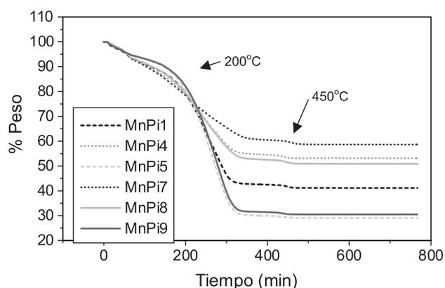
Figura 2.- Análisis termogravimétrico de las muestras del híbrido PPI/MnO<sub>2</sub>.
