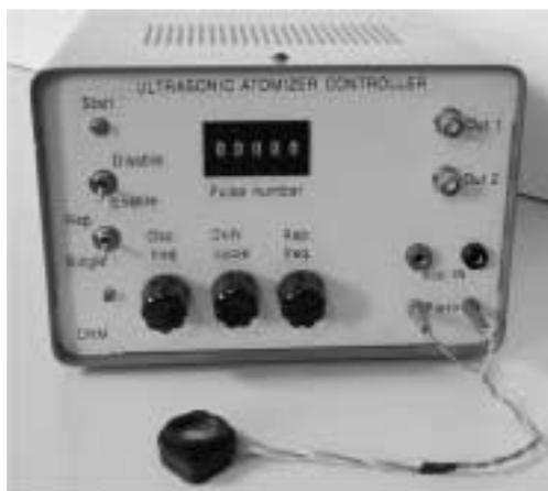
Figura 5. Fotografía del panel frontal del sistema de excitación de resonadores piezoeléctricos con el transductor PZT de 1,668MHz conectado a la salida.
