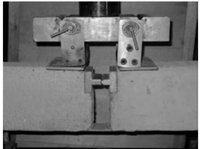
Fig. 4: Probeta en disposición de ensayo estático
