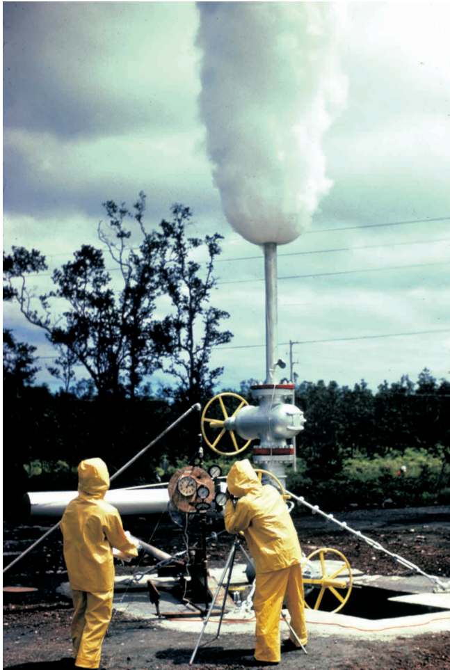
Figura 1. 22. Testificación en 1976 de la presión de un sondeo geotérmico perforado en la zona de rift del Kilauea. Este primer sondeo produce aún unos 3 megavatios de energía eléctrica, pero la producción total actual ha llegado a 30 megavatios y se espera que aumente en el futuro. (Fotografía cedida por el Hawaii Geothermal Project.)
