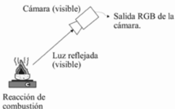
Fig. 2.- Caracterización de la temperatura en una reacción de combustión, utilizando radiación del visible.
