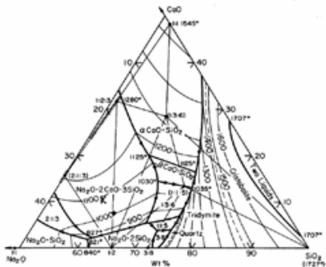
Fig. 1.- Composición del vidrio base K en el sistema Na 2 O-CaO- SiO 2
