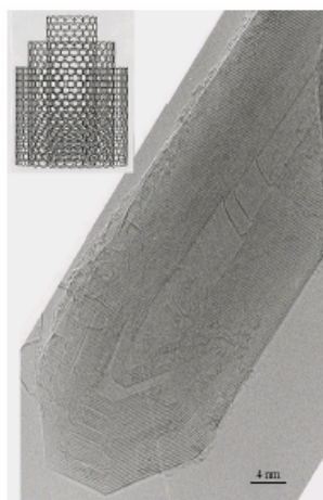
Fig. 10. Imagen TEM de un nanotubo de multipared concéntrico. Barra de escala, 4 nm. El diagrama insertado en la zona superior izquierda ilustra la disposición concéntrica de los grafenos. Adaptado de la Ref. [27].
