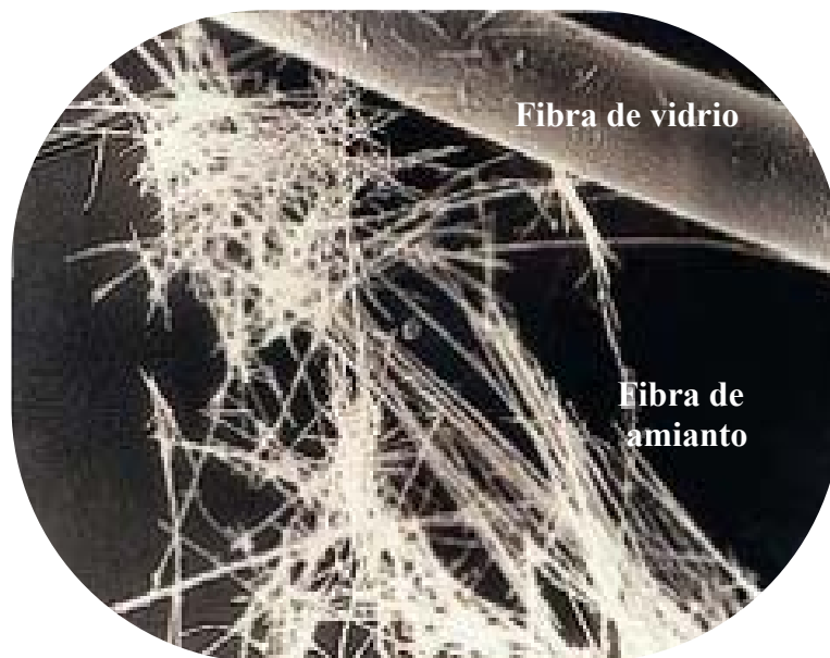
Figura 1: diámetro comparado entre la fibra de vidrio y la de amianto
