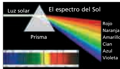
Figura 23.5. Líneas de Fraunhofer. El espectro de la luz solar aparece atravesado por líneas negras, correspondientes a los elementos que forman el Sol.
