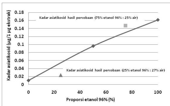
Gambar 1. Respon proporsi etanol vs kadar asiatikosid hasil maserasi pada suhu 50°C dengan persamaan  $Y = 0,1617 (X_1) + 0,0104 (X_2) + 0,0408 (X_1)(X_2)$
