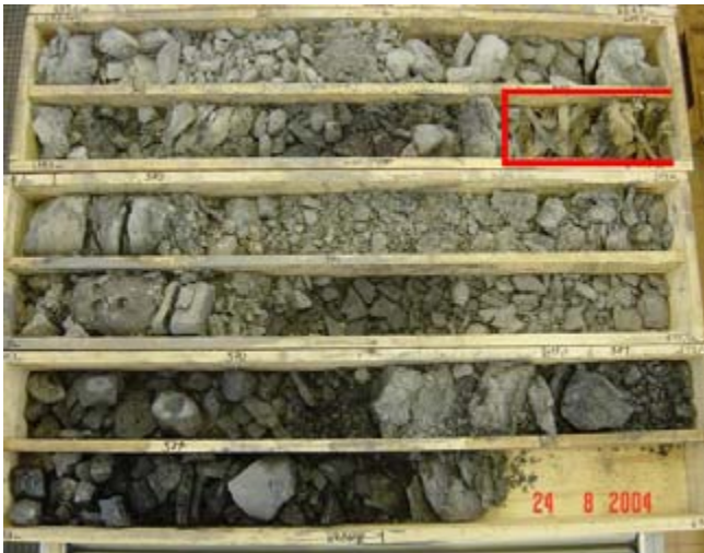
Abb. 4: Bohrkern mit angetroffenem Holzausbau bei 609,7 bis 610,0 m (rot markierter Bereich)
