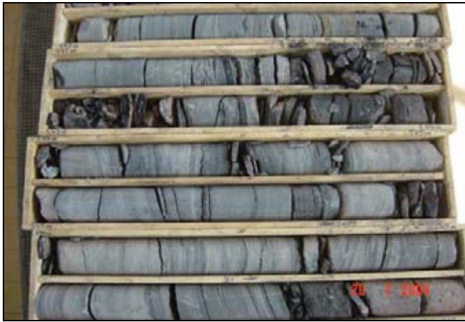
Abb. 21: Bohrung Oelsnitz 1A/2003 Teufenbereich 541,0-548,0 m Neuföz 2: 542,6-543,30 m, 543,55-544,00 m, 544,47-544,55 m, 545,64-545,77 m, 545,90-546,05 m, 547,59 547,78 m, 548,93-548,97 m
