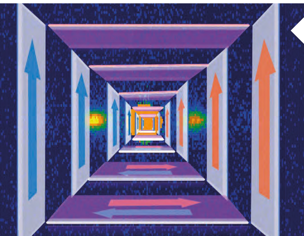
Abb. 1: Im Inneren eines Kristalls mit metamagnetischer Textur. Ein Blick in Modulationsrichtung zeigt periodisch abwechselnd Abschnitte mit lokal antiferromagnetischer links-rechts Konfiguration und mit ferromagnetischer senkrechter Konfiguration der magnetischen Momente. Das angelegte magnetische Feld zeigt senkrecht aufwärts. Der Bildhintergrund ist ein Detektorbild des Kleinwinkel-Neutronendiffraktionsexperiments im metamagnetischen Zustand. Satelliten um das Zentrum signalisieren ferromagnetische Beiträge zu der magnetischen Modulation.
