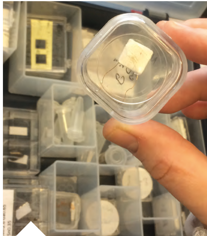
Abb. 3: Probe für NMR-Messungen verpackt in weißer Teflon-Folie und mit einer Kupferspule zum Senden und Empfangen von Radiofrequenzsignalen umwickelt. Die Probe wird in einer durchsichtigen Plastikdose aufbewahrt. Im Hintergrund sieht man weitere NMR Proben.
