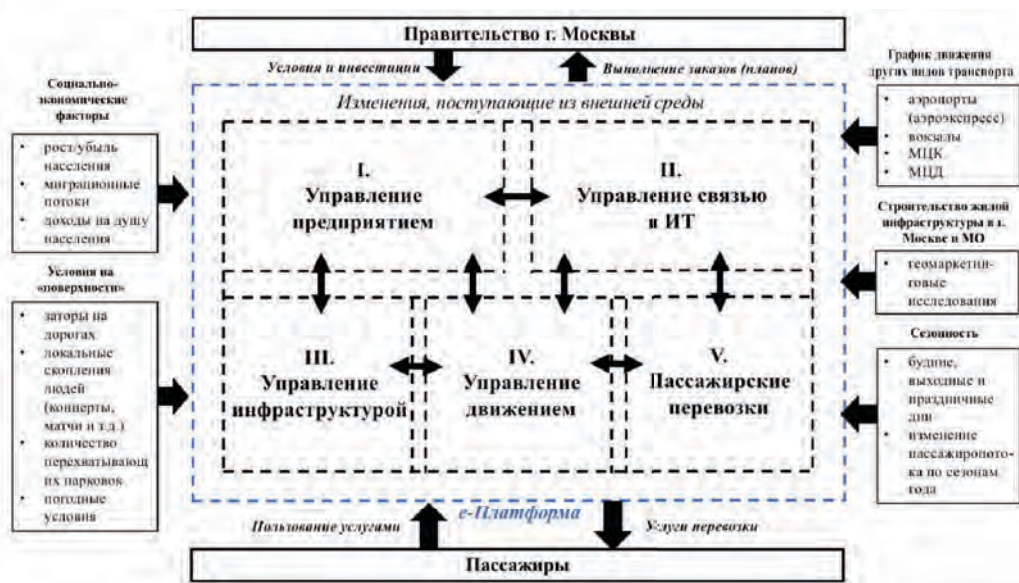
Рис. 1. «е-Платформа» автоматизированного управления бизнес-блоками и процессами метрополитена. Источник: составлено авторами.
