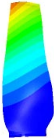
Fig. 7 Fan blade 1F mode shape
