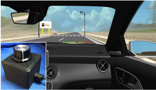
Bild 4.10: Drehknopf zur kontinuierlichen Bewertung von Inkongruenzen und die entsprechende Skala mit Zeiger als Head-Up-Display des Beifahrers
