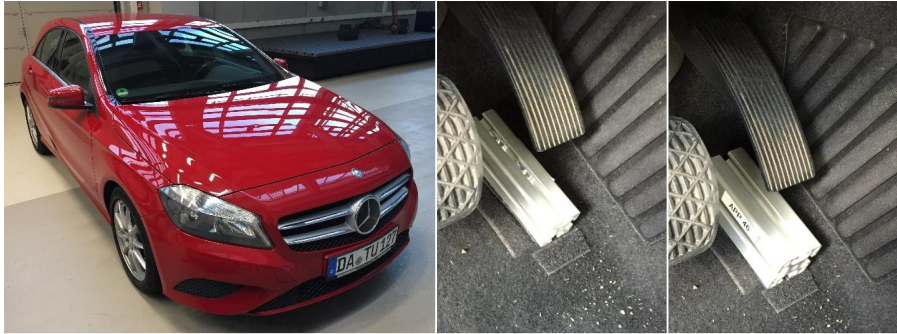
Bild 4.5: Versuchsfahrzeug und Fahrpedalblockierung zur Eingrenzung der Fahrpedalstellung
