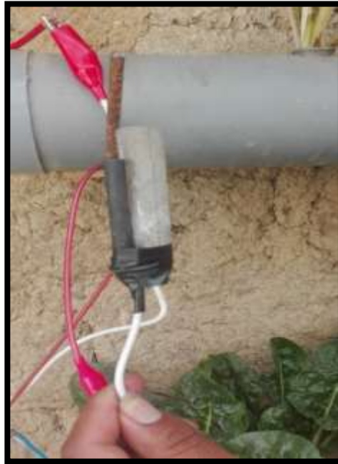
Figura N°3: Ánodo de magnesio y cátodo de carbón utilizados
