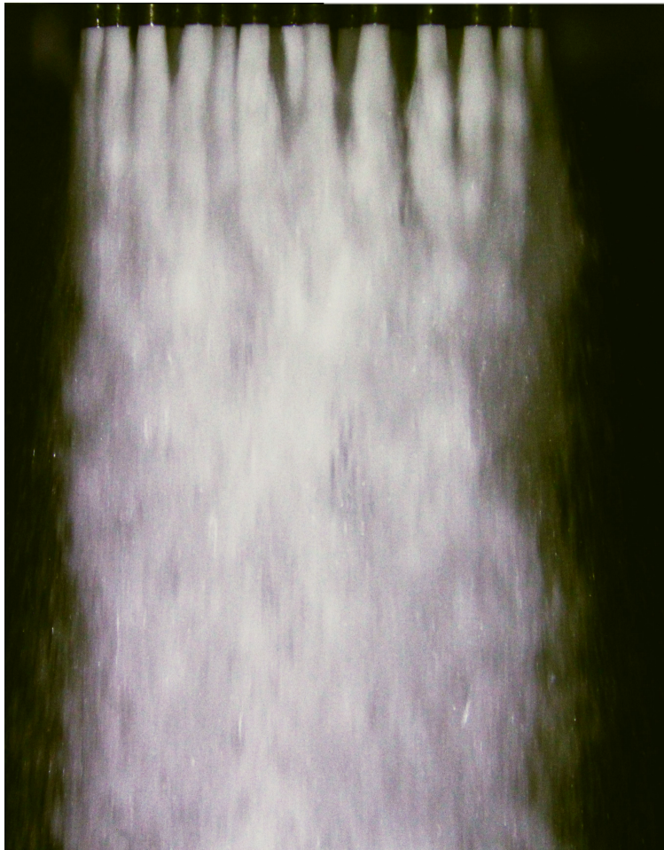
Abbildung 6.8: Spray des aus den Injektorröhrchen austretenden Wassers ( \dot{V} = 5 \frac{l}{s} , dP = 15 \text{ bar} ).
