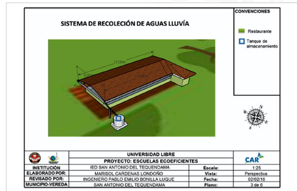
Figura 3.7 Ubicación y distribución del sistema de recolección de aguas lluvia.
