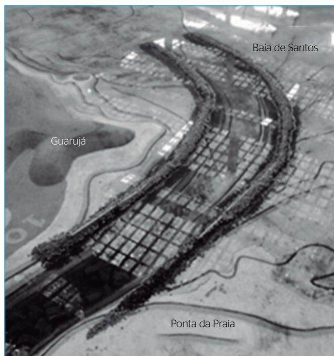
**Figura 5** - Configuração final dos molhes implantada no modelo físico.
