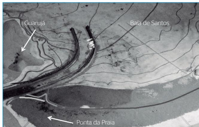
**Figura 14** - Tendência de evolução da linha de costa obtida durante o ensaio em modelo físico.
