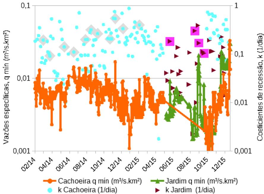
**Figura 6** – Coeficientes de recessão linear das vazões mínimas diárias no ribeirão Jardim e no córrego da Cachoeira. Valores de coeficientes de recessão médios independentemente das precipitações, indicados pelos pontos azuis (Cachoeira) e marsala (Jardim). Coeficientes de recessão médios para estiagens superiores a sete dias, losangos cinzas (Cachoeira) e quadrados magenta (Jardim).
