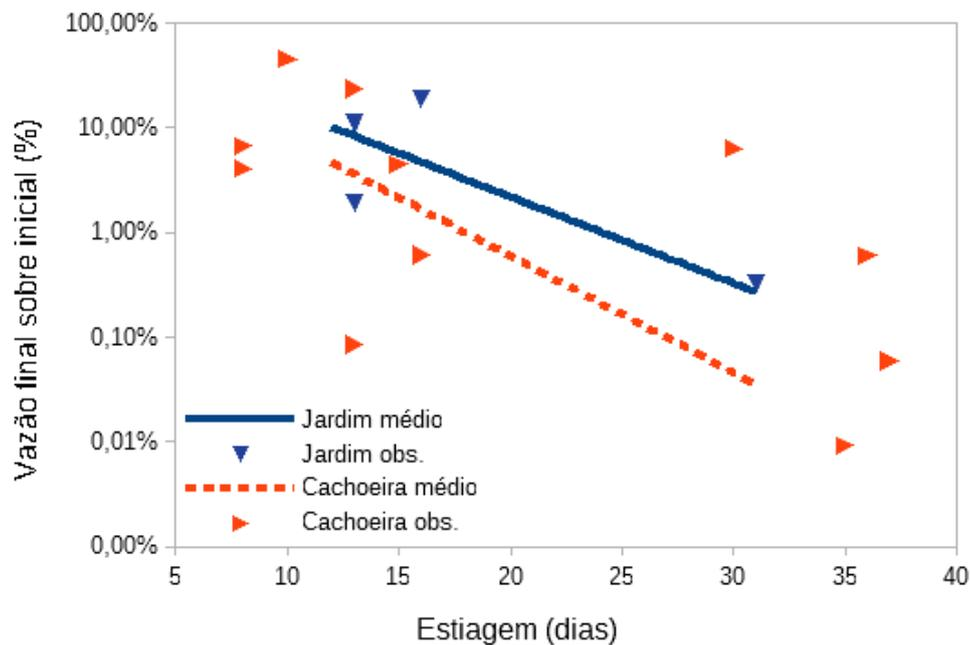
**Figura 7** – Porcentagem da vazão final sobre a vazão inicial em períodos de estiagem para o ribeirão Jardim e o córrego da Cachoeira. Linhas contínuas indicam quedas estimadas a partir da média dos respectivos coeficientes de recessão. Pontos em triângulos indicam (para baixo) as quedas observadas no ribeirão Jardim e (para a direita) no córrego da Cachoeira para estiagens superiores a sete dias.
