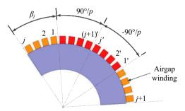
Fig. 3.4: Number of slot pair per pole pair.
