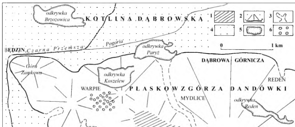
Rys. 13. Kopalnie odkrywkowe węgla kamiennego na tle szkicu geomorfologicznego pogranicza Kotliny Dąbrowskiej i Płaskowzgórza Dańdówki, stan z połowy XX wieku 1 – spłaszczenia wierzchowinowe, 2 – stoki, 3 – suche doliny erozyjno-denuwacyjne, 4 – doliny rzeczne, 5 – kopalnie odkrywkowe węgla kamiennego, 6 – warpia
