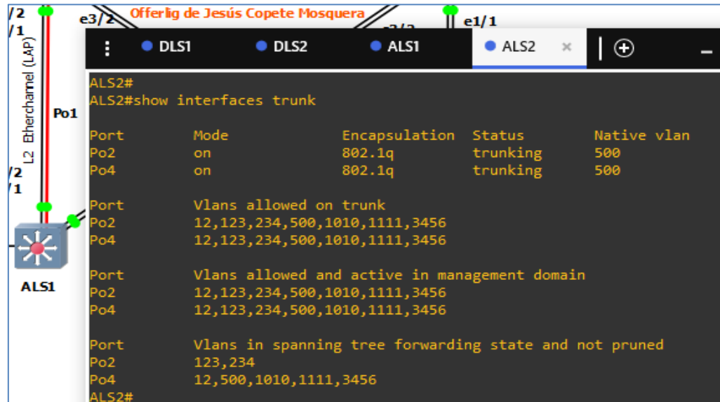
Figura 25. Verificación correcta de Puertos troncales ALS2
