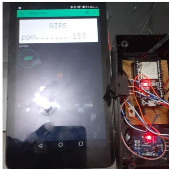
***Imagen 16 - Prototipo montado y funcional - fuente propia***
