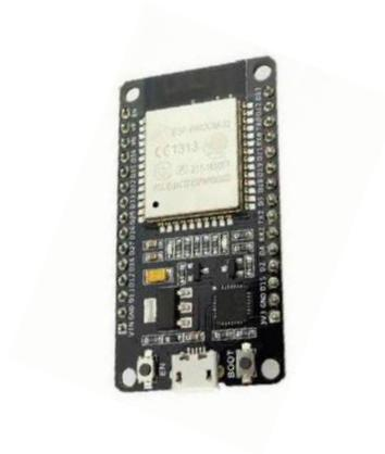
**Imagen 4 - Tarjeta de desarrollo ESP32 fuente <https://circuits4you.com/2018/12/31/esp32-devkit-esp32-wroom-gpio-pinout/>**
