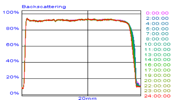
Fig. 3.1: Resultado del ensayo de estabilidad acelerada a 40 °C durante 24 h para una muestra de la emulsión 1 (A/O).
