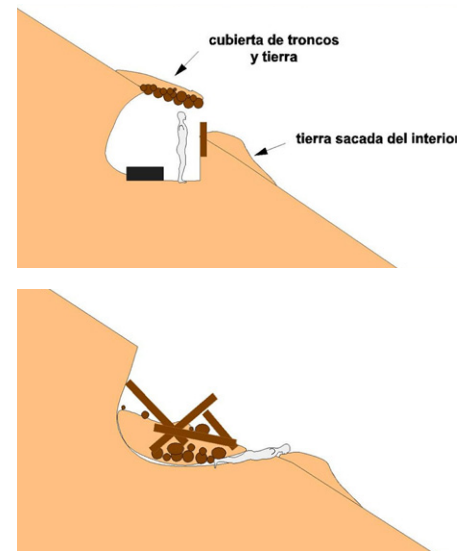
Fig. 1: Dibujo esquemático de la casamata en la línea de defensa de Intxorta (Gipuzkoa). Colapso producido por el impacto de un obús. FUENTE: propia
