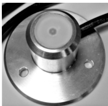
Figura 7: Radiómetro global desarrollado en el DES.
