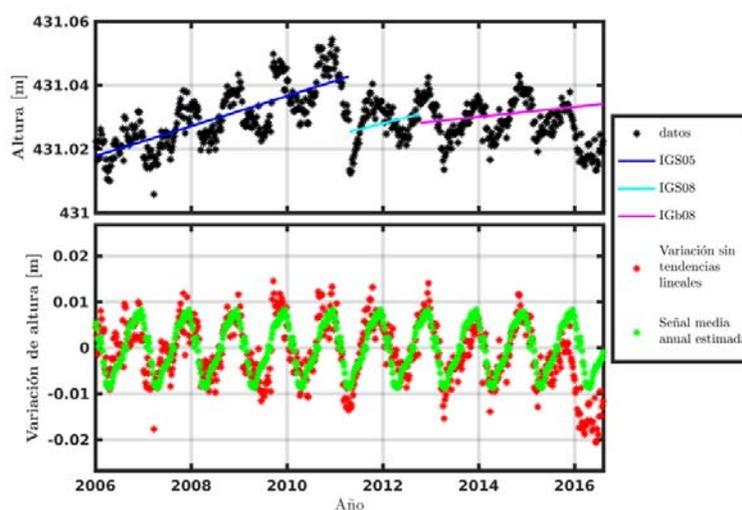
**Figura 13.** Preprocesamiento de la componente vertical de la estación PPTe.
