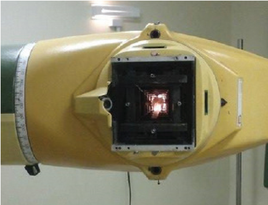
Figura 3. Irradiador Eldorado 78 (Energia Atômica do Canadá LTD, Chalk River, Canadá) com fonte de Cobalto 60.
