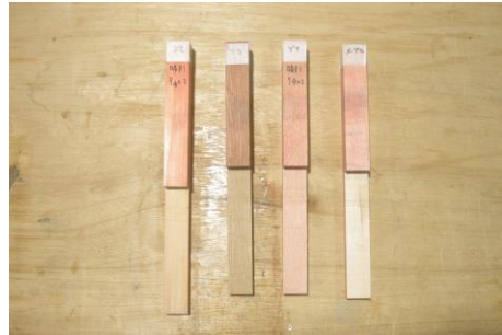
図8 反応染料を用いた吸引染色結果
