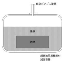
図6 超音波照射機能付き減圧装置および装置の機構略図
