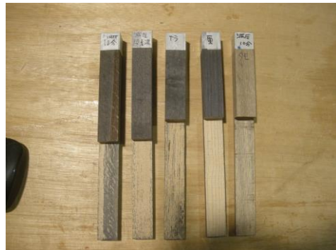
図9 鉄媒染液を用いた吸引染色結果
