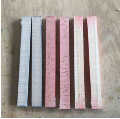
図 10 反応染料に助剤を添加した染色結果
