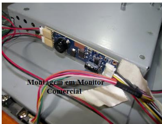
Figura 11 – Placa Driver Fixada na Lateral da Fonte
