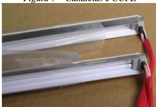
Figura 7 – Canaletas e CCFL
