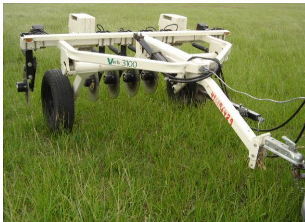
Figura 30. Sensor Veris 3100 usado para las determinaciones de conductividad eléctrica aparente (CEa).
